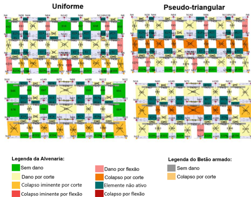
Figura 6. 8 - Padrão de danos das paredes de fachada (P1 em cima e P3 em baixo) para os diferentes carregamentos aplicados na direção X para o deslocamento último.
