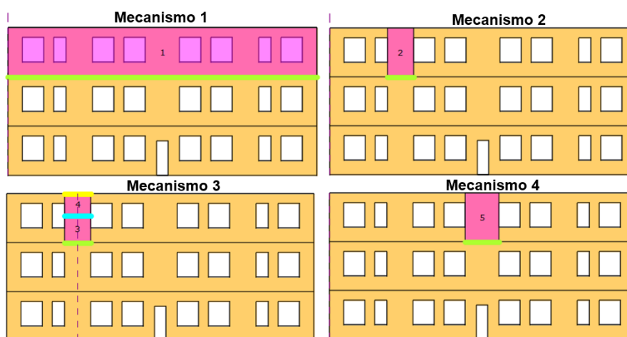
Figura 4. 22 - Mecanismos de colapso identificados na parede de fachada tardoz.
