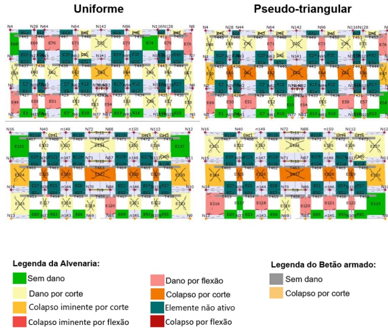
Figura 6. 5 - Padrão de danos das paredes de fachada (P1 em cima e P3 em baixo) para os diferentes carregamentos aplicados na direção X para o deslocamento último.
